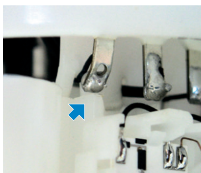
Abb. 2: Durch zu starkes Zusammen-drücken des Kraftstofffördermoduls wird das Kabel abgeschert.
